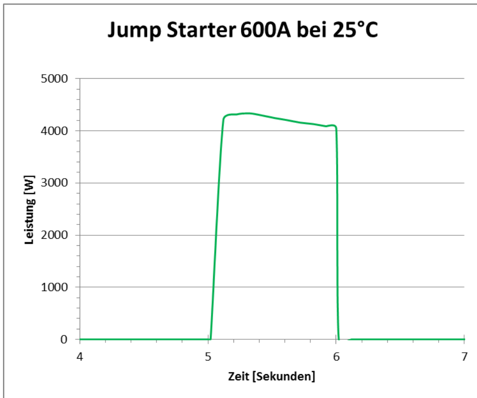
Bild 12 Berechnete Leistung beim Entladen des Ausgangs Jump Starter mit dem 600A-Puls
