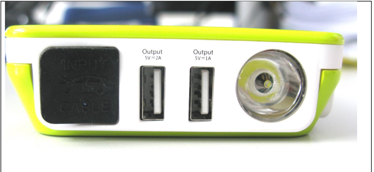
Bild 2 Ausgänge Jump Starter (links, mit Abdeckung), USB 2A, USB 1A, und LED-Leuchte
